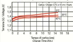
Fig. 3 Effetto della temperatura sulla carica normale Effect of temperature on standard charge
